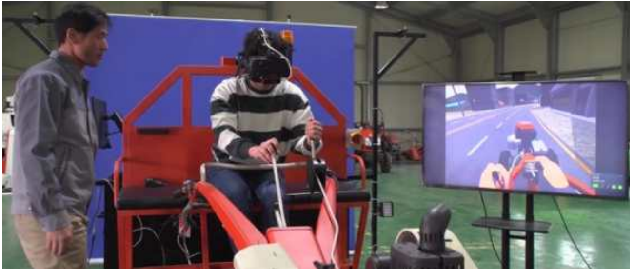
(그림) 경운기 안전교육용 시뮬레이터
