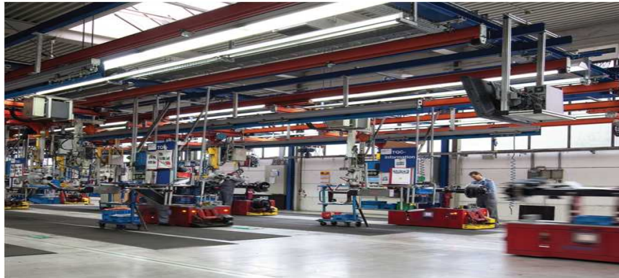
그림. 자동차 조립라인 AGV용 WPT system (10kW)
