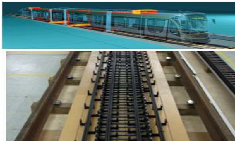
그림. 전기철도용 WPT System ( 240kW)
