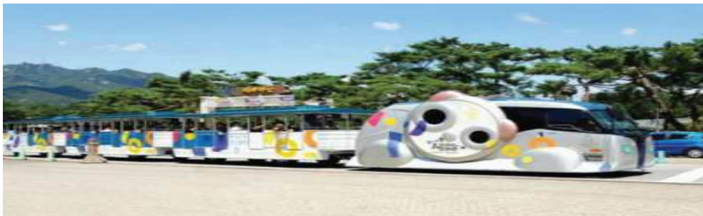
그림. 서울대공원 코리리열차용 WPT System (60kW)
