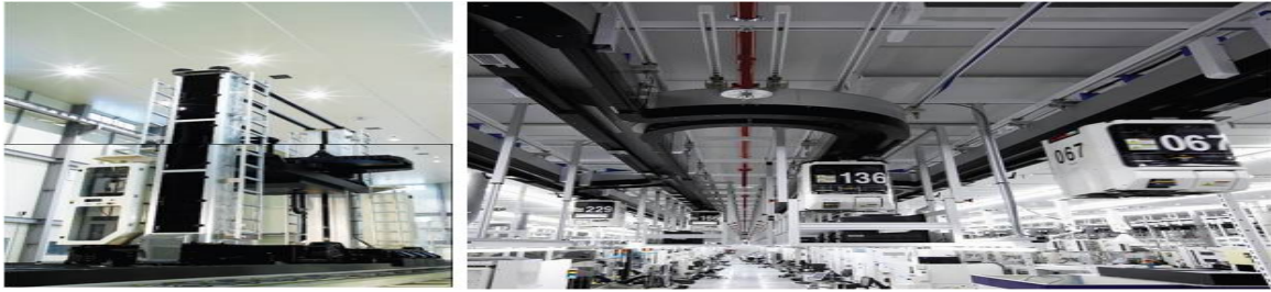
그림. 반도체 및 LCD 물류 시스템용 WPT System (2kW ~ 120kW)
